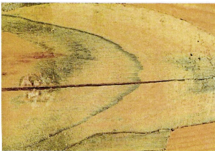
6 Positives Farbbild eines tangential aufgeschnittenen Furniers von der Rückseite einer Reliefintarsie am Egerer Kabinettschrank (s. Abb. 5)
